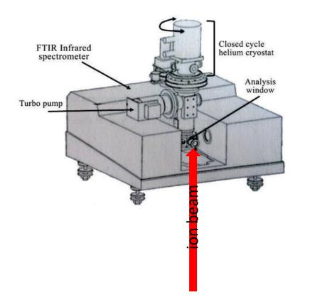
CASIMIR set-up Chambre d'Analyse par Spectroscopy Infrarouge desMolécules IRradiées
